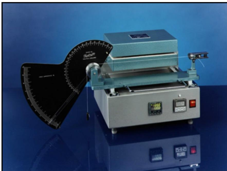
该仪器最初设计用于邓禄普公司的技术配套中，在精确温度控制下检测轮胎帘线的收缩率，改良以后已经可以用于 1 寸宽的纺织品了，包括纱线和单纤维等。样品被暴露于受控制的气体中，在两个 10 寸宽的压盘中控制温度，伸缩率可以在表盘上显示。剩余的收缩率可以在样品取出冷却后得到。
